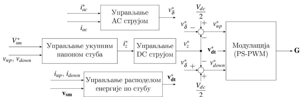
Slika 3 Blok dijagram klasične kontrole MMC-a
